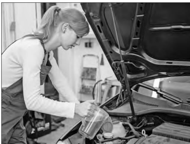
Антифриз – це концентрована рідина на основі етиленгліколю, яку ви змішуєте з водою і використовуєте для заповнення системи охолоджувальної вашого автомобіля. Як впливає з назви, антифриз запобігає замерзанню охолоджувальної рідини вашого двигуна при мінусових температурах. Захист від замерзання також допомагає запобігти утворенню відкладень і корозії в двигуні, а також покращує передачу тепла від нагрітого двигуна до охолоджувальної рідини.
